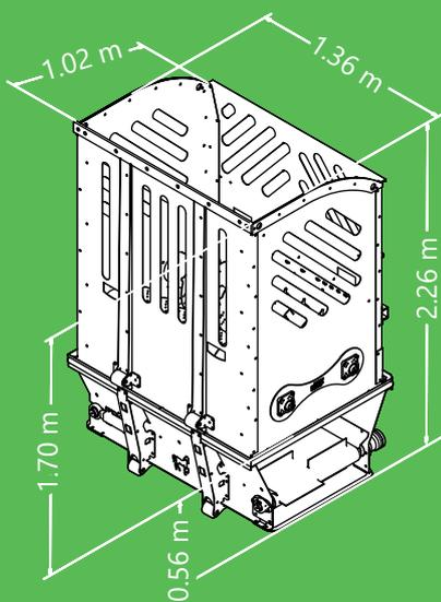
Der Stableboy findet seinen Einsatzbereich im Verteilen von Heu und Stroh in Quaderballen. Maximale Quaderballen Abmessungen (LxBxH) 1.20x0.90x1.20 m. Das Trägergerät sollte über eine Kipplast von mindestens 650 kg verfügen.
